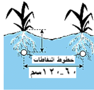
شكل (٢-٢). نموذج لشبكة ري بالتنقيط التحت سطحي
