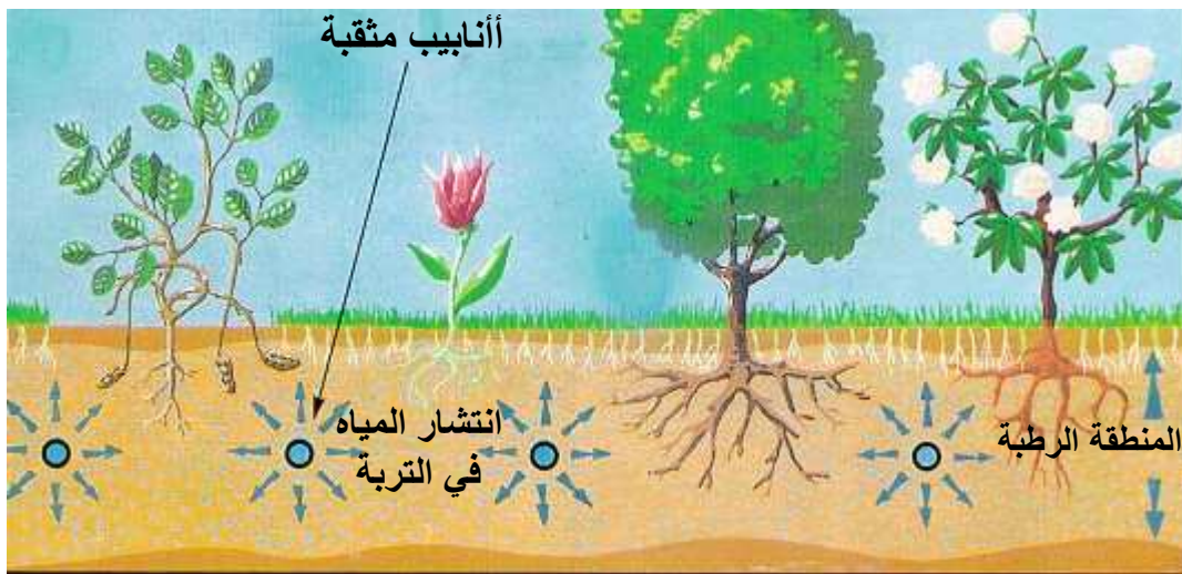
شكل (٢-٢). نموذج لشبكة ري بالتنقيط التحت سطحي
