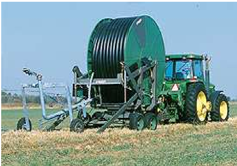
شكل (٢-٣٣). النظام المدفعي ذو البكرة
