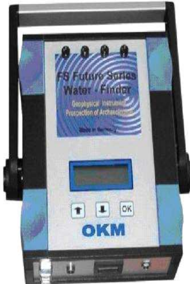
شكل (٦-١). جهاز كهربائي للكشف عن المياه الجوفية
