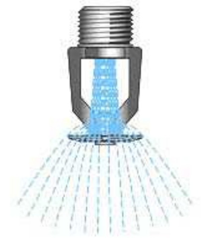
شكل (٢-٢٠ب). خروج الماء من الرشاش الثابت
