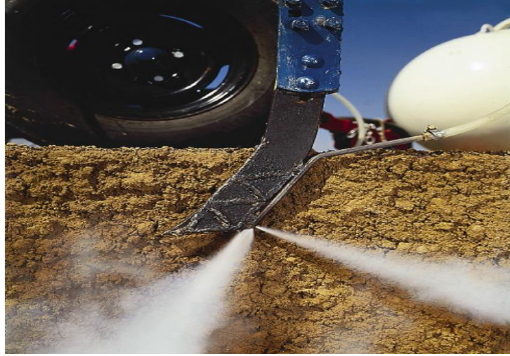
شكل (1-2) يوضح تنكات الأسمدة النشادرية السائلة وطريقة إضافتها للتربة
