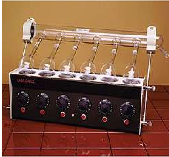
( شكل 128 ) وحدة الهضم
