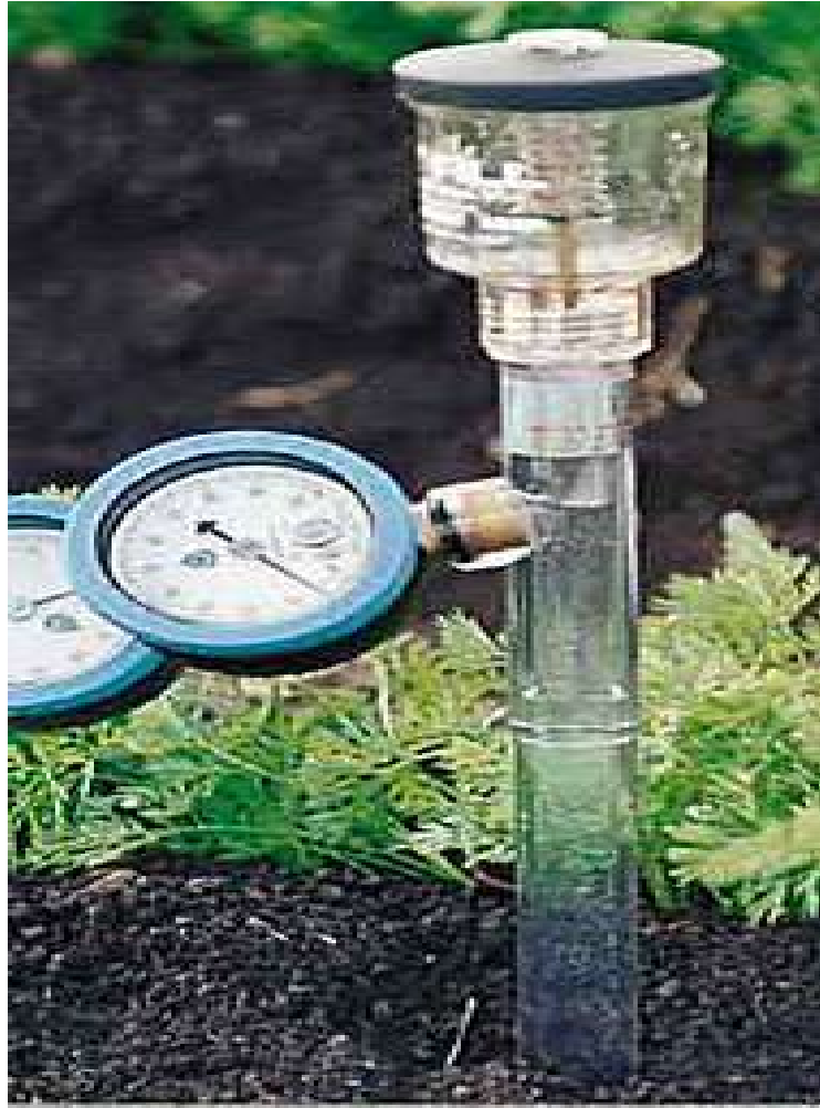
شكل ( 105 ) يوضح كيفية تثبيت التنشيومتر لقياس الرطوبة الأرضية
