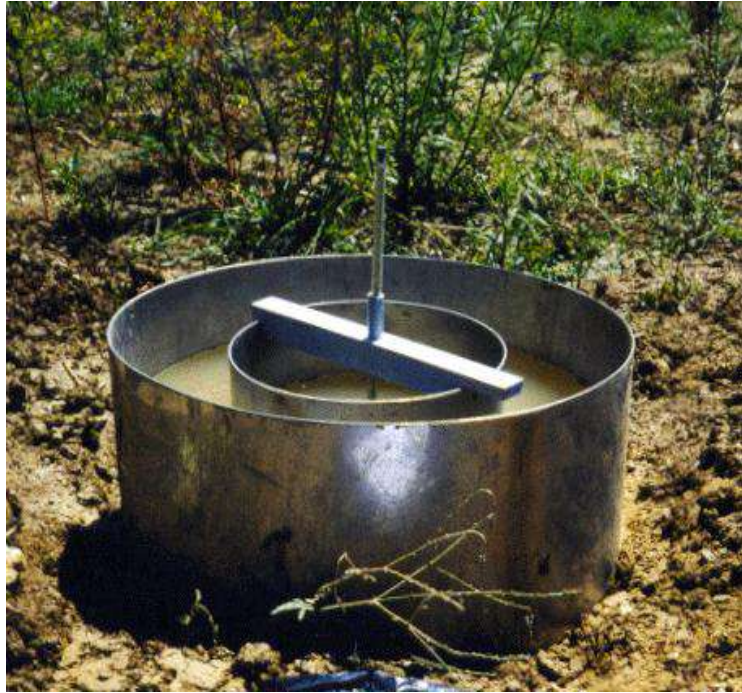
( شكل 107 - ب ) كيفية تثبيت الاسطوانتين لتقدير معدل رشح الماء في الأرض
