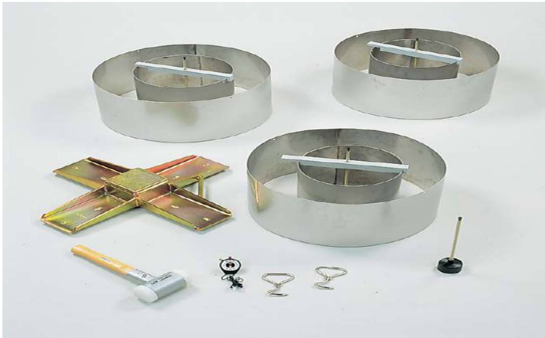
شكل ( 106 ) الاسطوانة المزدوجة ومحتوياتها
