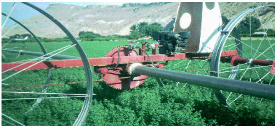
الشكل رقم ٣/١٤. المحرك والتروس المستخدمة مع أنبوب الرشاشات المحمول على العجلات
