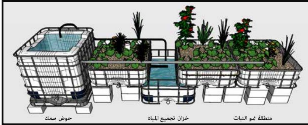
شكل (10-12) رسم توضيحي لوحدة مرقد بيئات النمو الصلبة على نطاق صغير
