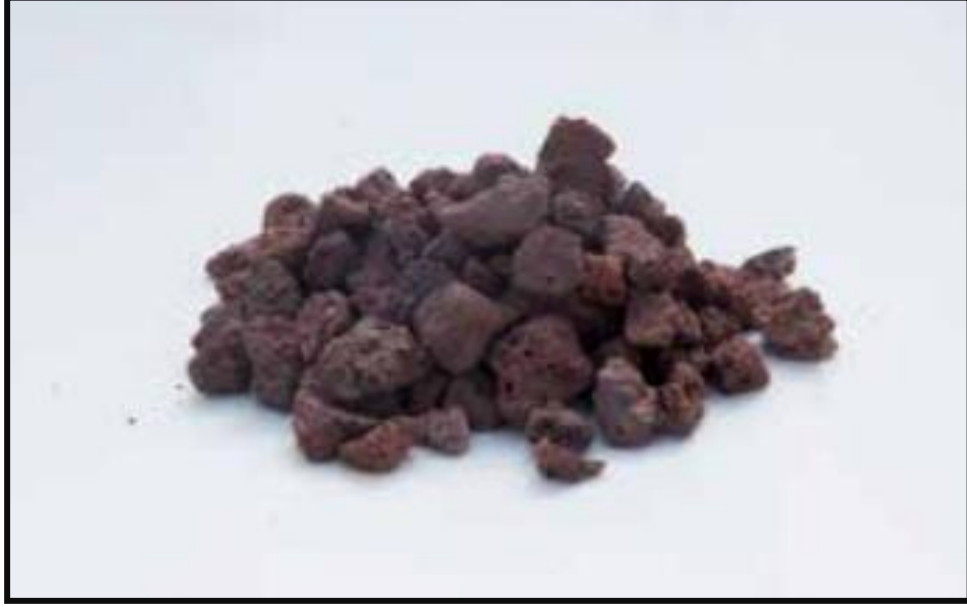
شكل (10 - 31) الحصى البركاني يستخدم في وحدات المراقد كبيئات للنمو
