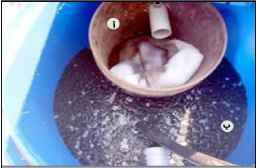
شكل (10 - 22) مقطع أفقي يوضح مرشح بيولوجي: (أ) مرشح ميكانيكي بيولوجي، (ب) وسائط المرشح الحيوي
