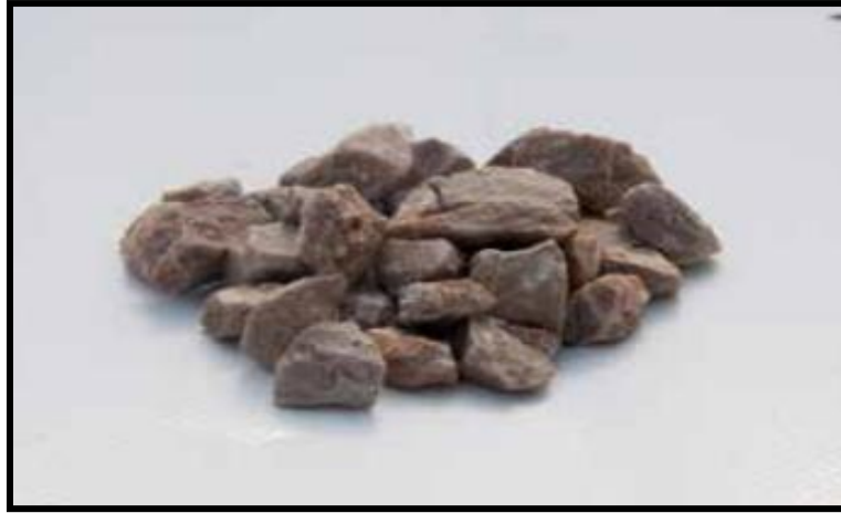
شكل (10 - 32) حجر جييري يستخدم في وحدات مرقد كوسائط للنمو
