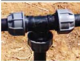
55 وصلة على شكل حرف "T" بلاستيكية PVC (25 ملم)
